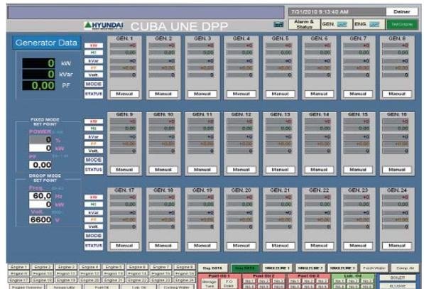
Figura 1: Mímico **GPCCtrl.pdl** donde se visualizan los parámetros eléctricos del generador.
