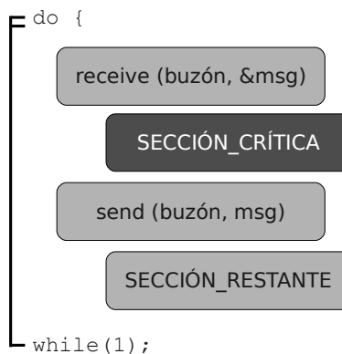
Figura 3.6: Mecanismo de exclusión mutua basado en el uso de paso de mensajes.
