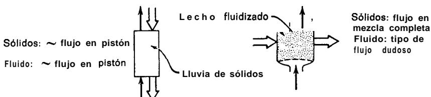
Fig. 15-2. Para la experimentación cuando la desactivación es lenta puede utilizarse una carga de sólidos; cuando la desactivación es rápida se requiere un flujo de sólidos.
