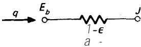
Fig. 8-24 Elemento que representa una "resistencia de superficie" en el método de red de radiación.
