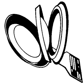
Fig. 6 Los discos de ruptura protegen los sistemas del proceso
