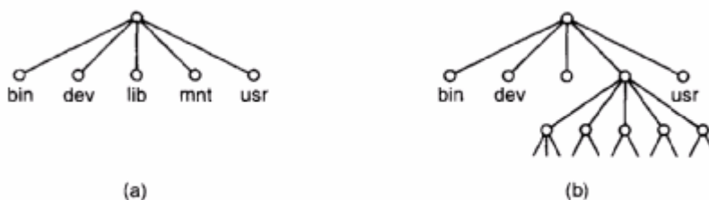
Figura 1-15. Sistema de archivos (a) antes del montaje y (b) después del montaje.
