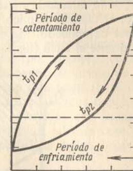
Fig. 8-8. Carácter de la variación de la temperatura en la superficie de la estructura de un regenerador (anillo de temperatura) durante el período de calentamiento t_{p1} y el de enfriamiento t_{p2} .
