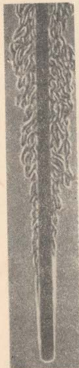
Fig. 3-24. Movimiento libre del aire a lo largo del tubo vertical calentado.
