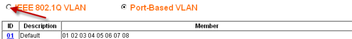
Fig. 5: Enable 802.1Q VLANs
