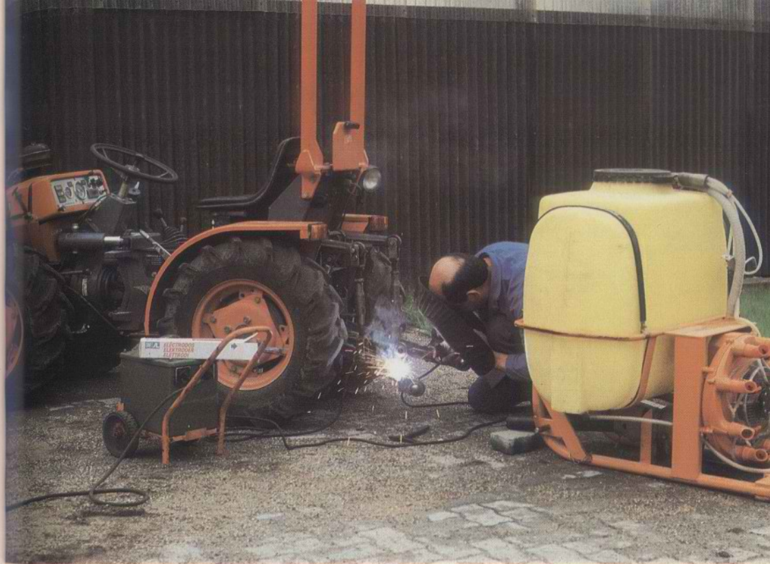
Adaptación de un sistema de alzado: reparación de una barra de corte.
