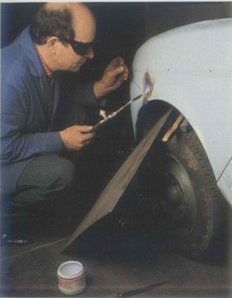
Soldadura de reparación de la carrocería de un coche con una soldadura oxiacetilénica siendo el latón el metal añadido.
