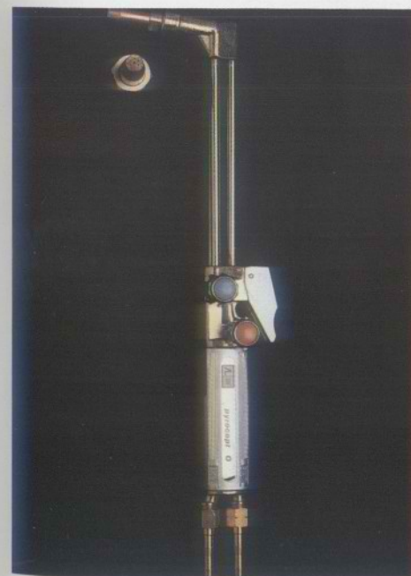
Arriba: un soplete soldador, a ser posible con una adaptación de una boquilla de corte y un soplete oxhídrico provisto de una cabeza de corte.
