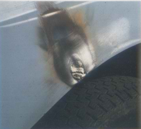
Soldadura de reparación de la carrocería de un coche con una soldadura oxiacetilénica siendo el latón el metal añadido.
