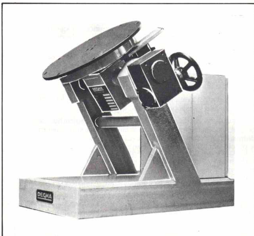
Figura 73. Mesa posicionadora utilizada en soldadura.
