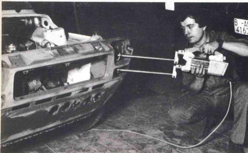
Figura 34. Aparato portátil para la soldadura por puntos.
